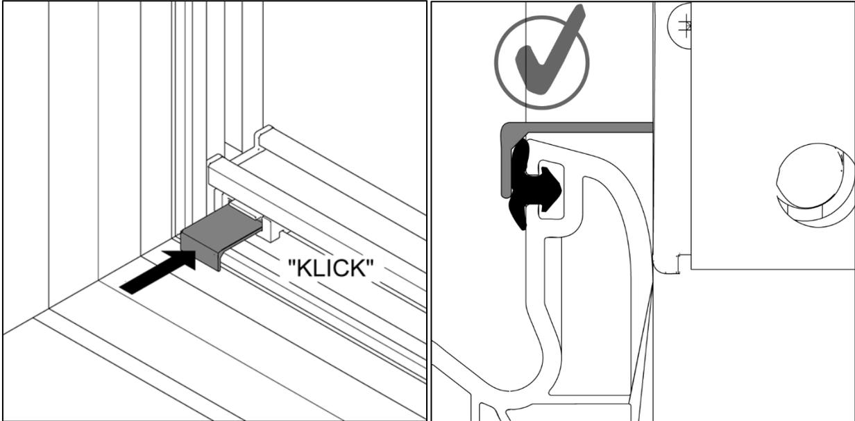
Alle fünf Clips fest eindrücken und das Rollo möglichst plan am Fensterrahmen sichern!
