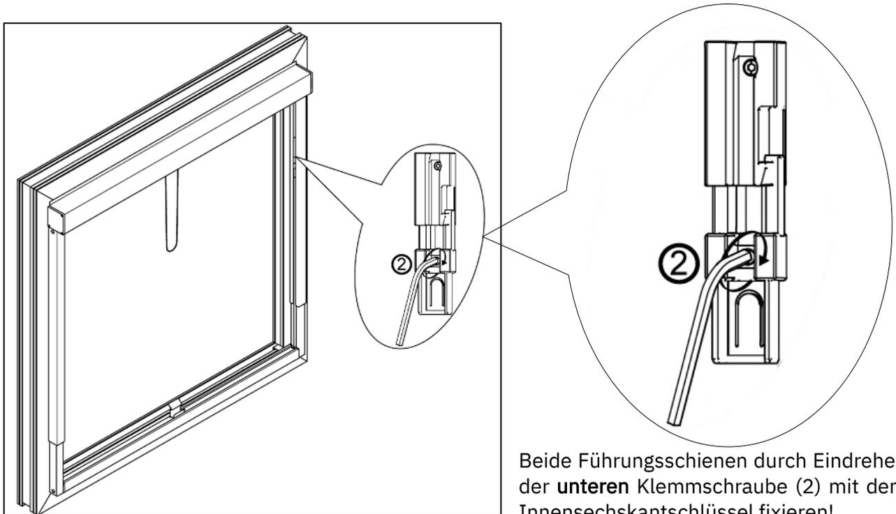
Beide Führungsschienen durch Eindrehen der **unteren** Klemmschraube (2) mit dem Innensechskantschlüssel fixieren!
