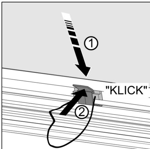
Rollo nach unten ziehen und die Griffleiste in das Bedienelement einrasten!
