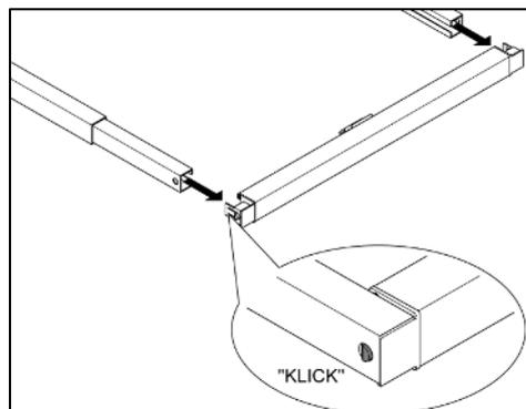
Beide Führungsschienen auf das Verbindungsprofil aufstecken und einrasten!
