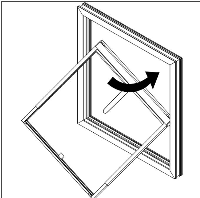
Fertig montiertes Rollo nach außen vor das Fenster führen!
