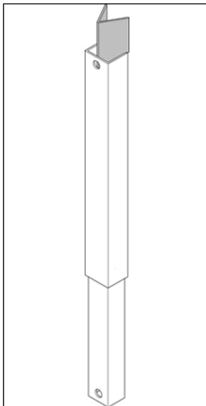
Die kleinere Führungsschiene etwas nach unten herausziehen!
