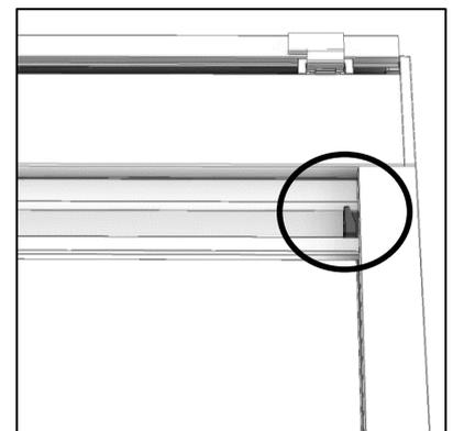
Kassette auf beide Führungsschienen aufstecken und einrasten!
