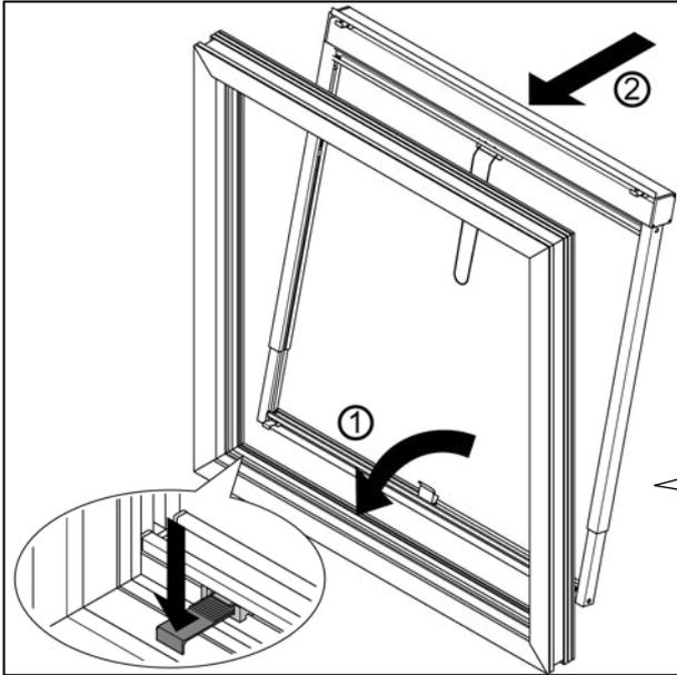
Das Rollo mit den unteren Clips über den Fensterstock einsetzen!
