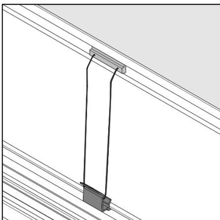
Zugschnur **außen** in Bedienelement einhängen und Rollo in Zwischenstellung positionieren!
