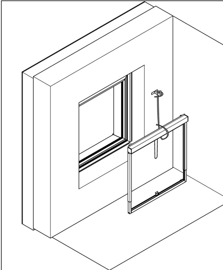
Kassette mit beiliegender Montagehilfe (Schnur) verknoten und loses Ende an einem, fest mit dem Mauerwerk verbundenen, Gegenstand sichern! (z.B. Heizung, Fenster, etc.)
