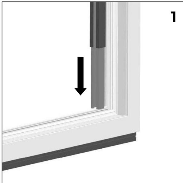
1. Führungsschiene bei geöffnetem Fenster unten auf den Fensterrahmen aufsetzen!
