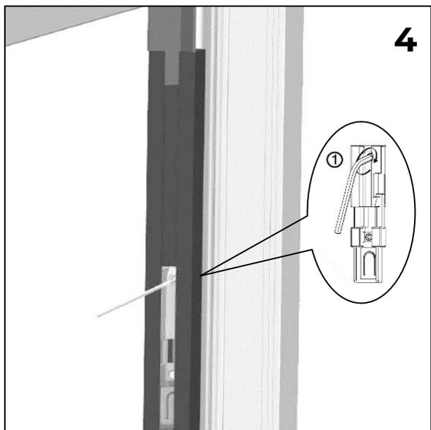
4. Höhe der Führungsschiene durch Festziehen der **oberen** Klemmschraube (1) mit beiliegendem Innensechskantschlüssel fixieren!
