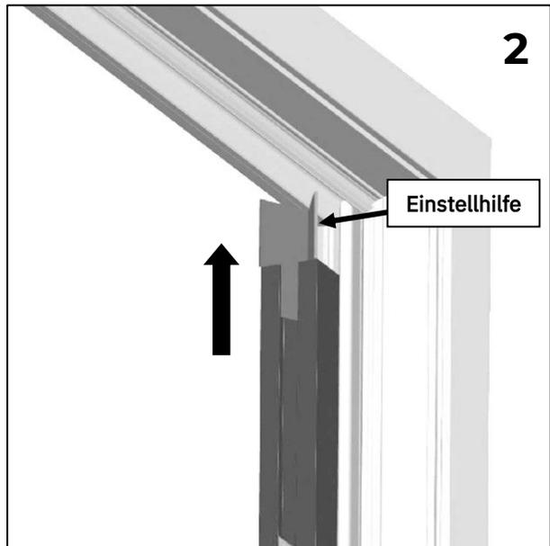
2. Führungsschiene nach oben schieben, bis die Einstellhilfe oben am Fensterrahmen anschlägt!
