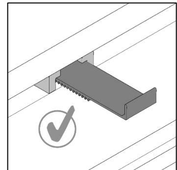
Die 5 ausgewählten Clips in die dafür vorgesehene Aufnahme (2x Kassette, 3x Verbindungsprofil) stecken. **Je nach Fensterart, können es im Verbindungsprofil auch mehr als 3 Clips sein!**
