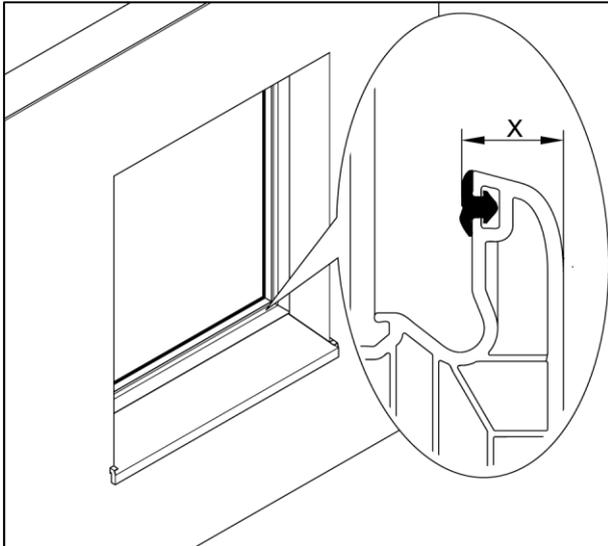
Stocküberschlag (X) des Fensterrahmens - bei geöffnetem Fensterflügel - ausmessen und passenden Clip (siehe Tabelle) auswählen! Beim Messvorgang die Gummidichtung (falls vorhanden) zusammendrücken!
