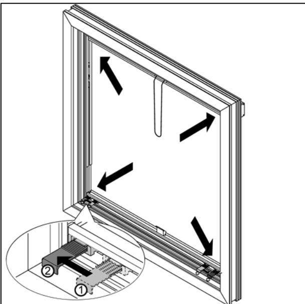
Alle vier äußeren Clips nach außen verschieben, den unteren mittleren Clip mittig positionieren und das Rollo mittig zum Fenster ausrichten!
