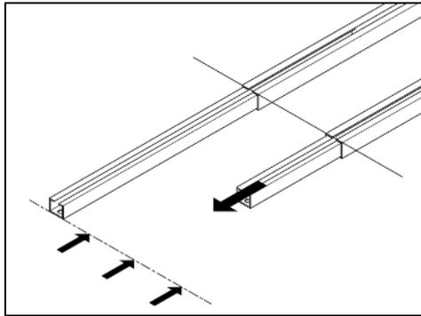
Zweite Führungsschiene auf gleiche Länge wie die Erste ausziehen!
