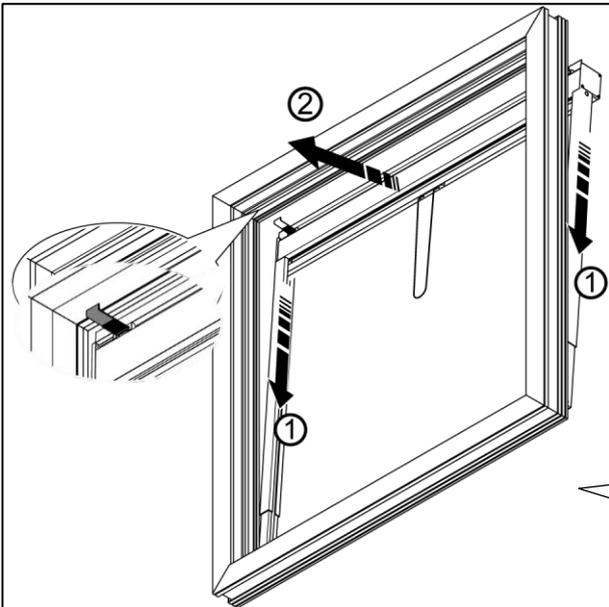
Führungsschienen leicht nach unten drücken und dadurch einfedern!
