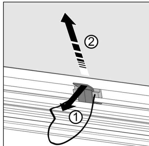
Bedienelement lösen und Rollo nach oben fahren! Rollo fährt selbständig und gebremst nach oben!
