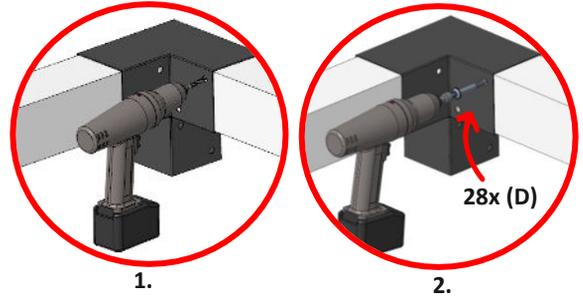
1. Vorbohren: 6 mm Holzbohrer (Tiefe: ca. 85 mm)
