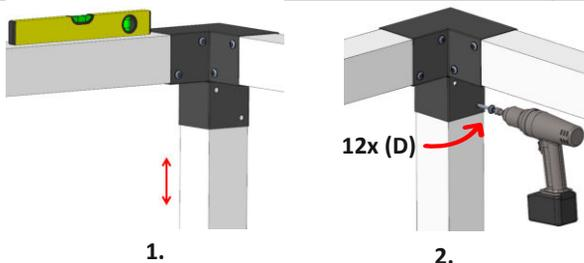
1. Pfosten ausrichten (Bodenebenheiten ausgleichen)
