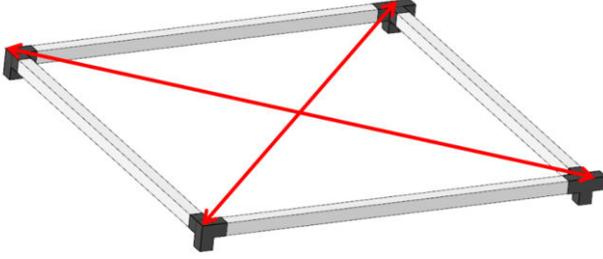
Ausrichten: Diagonalmessung des Rahmens
