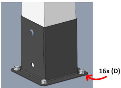
1. Vorbohren: 8 mm Betonbohrer (Tiefe: ca. 110 mm)
